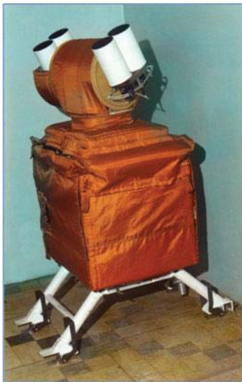
Рисунок 4 – Терминал для проведения космических экспериментов по лазерной связи на трассе Борт-Земля для МКС
