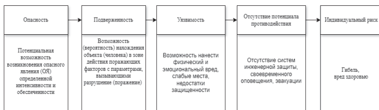
Рисунок 1 – Структурная схема формирования индивидуального риска гибели и получения вреда здоровью в ЧС
