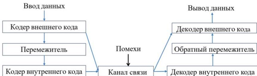
Рисунок 1 – Структурная передачи данных с применением ГПКК
